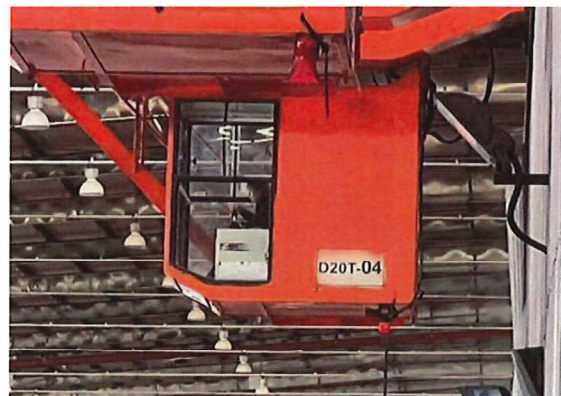
ภาพที่ 48 สัญญาณเสียง และไฟเตือนภัยของระบบเครน
